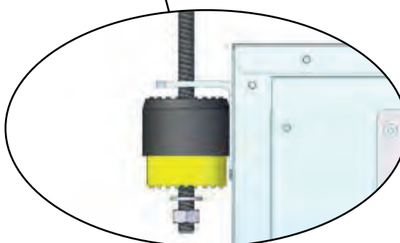
Posizionamento corretto per giunto antivibrante (non fornito)
